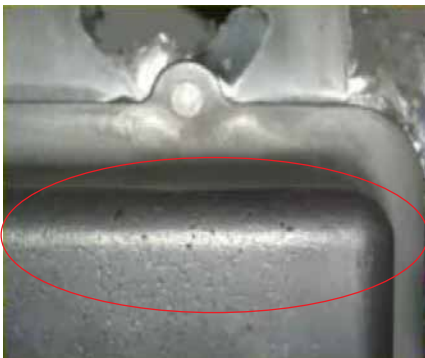
Şekil 15: Kaviteasyon, oyukçuklanma sorunu.
