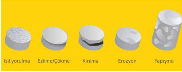
Şekil 1: Metal enjeksiyon kalıplarında hasar mekanizmaları
