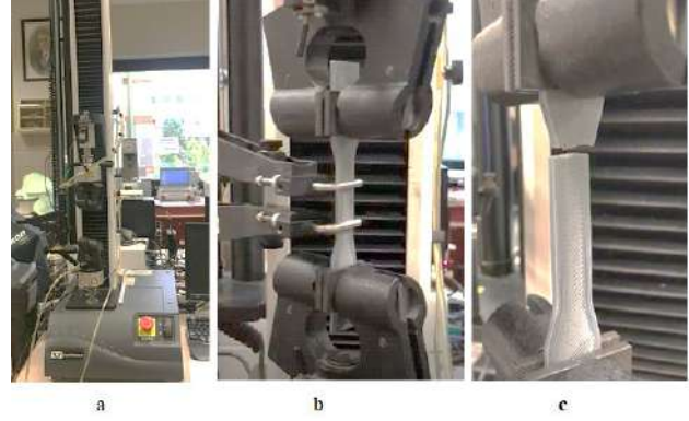
Şekil 19: Instron 3345 Çekme testi cihazı (a), Çekme testi öncesi numunenin konumu (b), Çekme testi sonrası PLA numunenin görüntüsü (c). [32].
