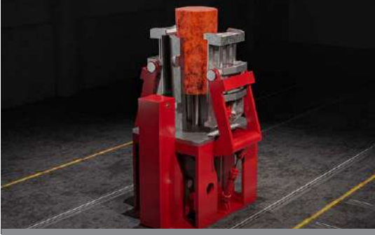
Şekil 1: Doldurulmuş kalıbın kesit görünümü ile blok itici
